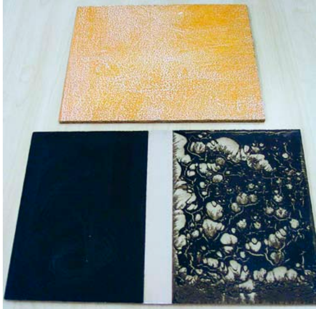
Difetti di bagnatura nelle vernici acriliche causate da distaccanti su piastre rivestite con PVC.
