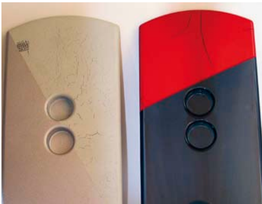
Fessure da tensione causate dall'azione di solventi (vernice PUR 2K) su pezzi stampati in policarbonato.
