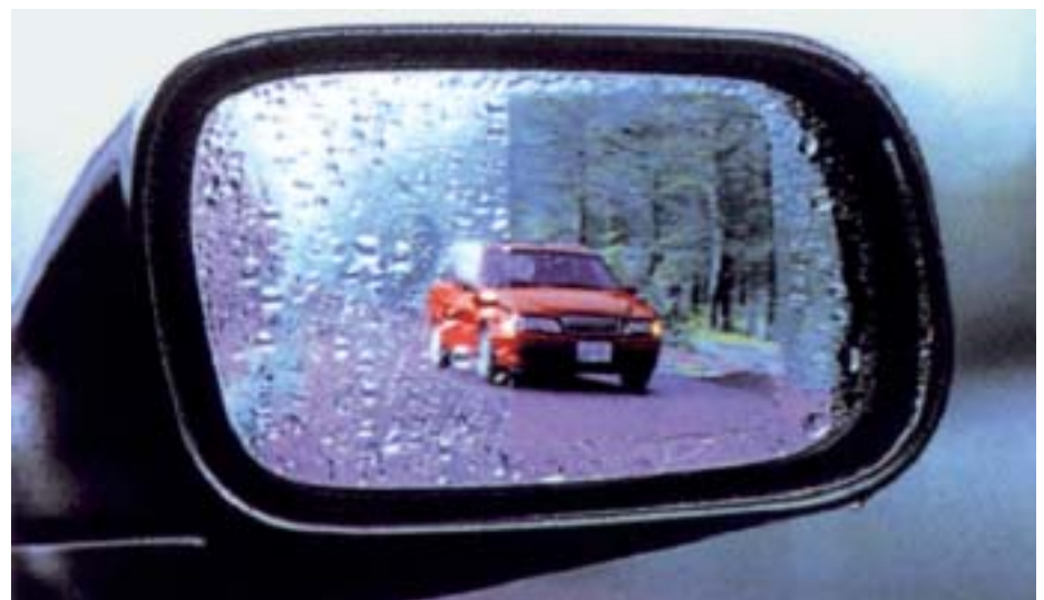
3 Die transparente Polymerfolie auf dem rechten Teil dieses Aussenspiegels weist eine fotokatalytisch aktive Titandioxidschicht auf, die durch UV(A)-Bestrahlung eine superhydrophile Oberfläche erhält, wodurch eine Beschlagsbildung verhindert wird.
