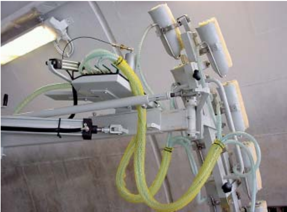
Der Beschichtungsarm ist bis auf fünf Meter Länge ausziehbar.
