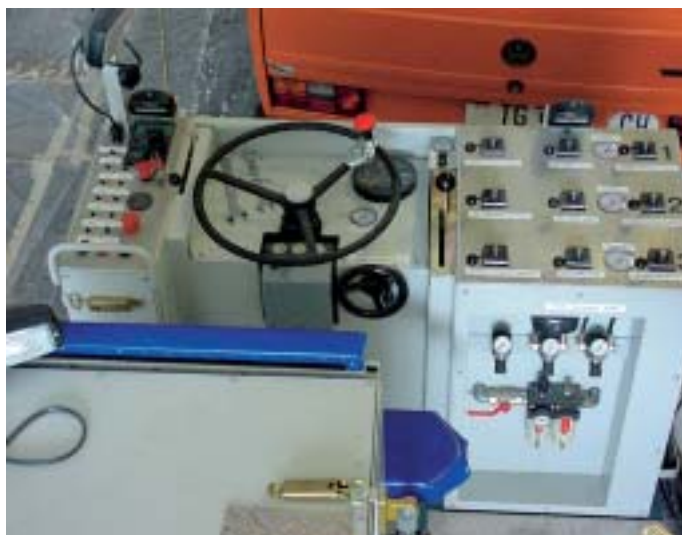
Bedienungspult des Beschichtungsroboters.
