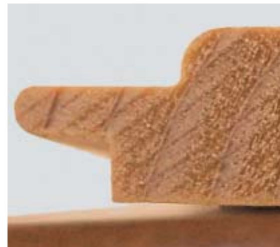
Gerundete Kanten gewährleisten gleichmässige Schichtdicken des Beschichtungsmaterials.
