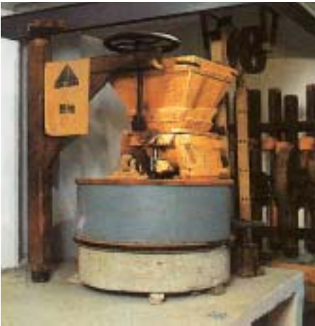
Eine Gipsmühle, mit der das gewonnene Gestein – nach dem Zerkleinern in einer Stampfe – gemahlen wurde.
