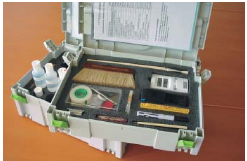
Mit einem Prüfset lässt sich ein Gipsuntergrund oder eine Altbeschichtung einfach auf seine bzw. ihre Tragfähigkeit prüfen.
