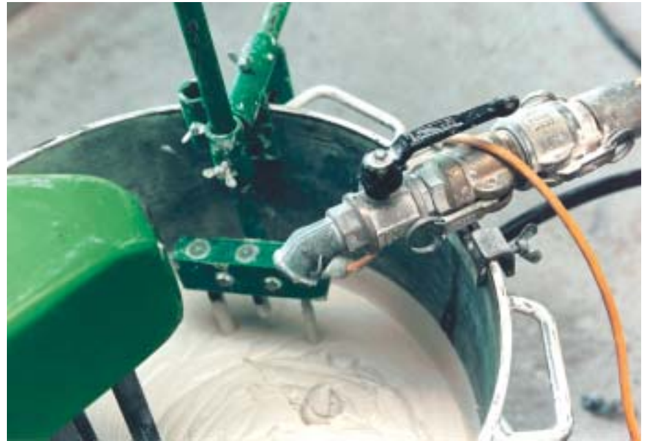
Der Materialtransport erfolgt von einer zentralen Stelle aus an den gewünschten Ort. Eine Füllstandsonde regelt den Materialfluss.
