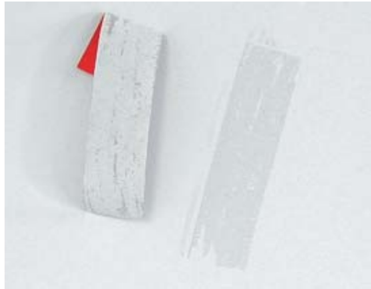
Der Test mit Betonklebeband liefert bei dispersionsgebundenem Spritzspachtel (links) das bessere Resultat als bei (grundiertem) Weissputz.
