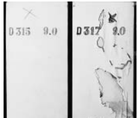
Bild 8: Dispersions-Lackfarben. Anstrich über gealterten Alkydharz-Anstrich nach 5-jähriger Bewitterung. D 315 = mit guter Nasshaftung, D 317 = mit mangelhafter Nasshaftung
